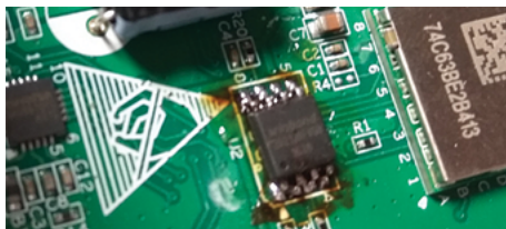
Rys. 15 Przykład śladów po manipulacji przy kości pamięci
